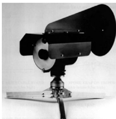
Figura 1. Caça-esporo usado na captura das partículas sólidas em suspensão nos pomares.
