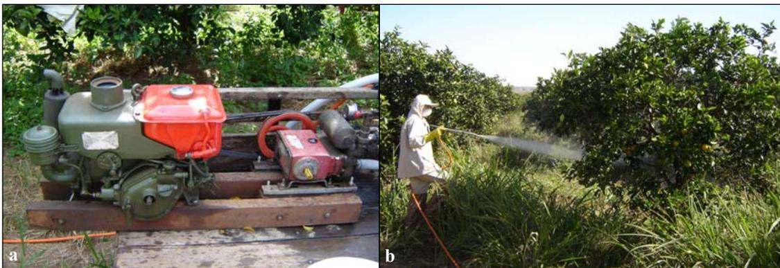
**Figura 1.** Forma de aplicação dos produtos. a) Motor estacionário, a diesel, acoplado a uma bomba de pressão equipada com pistolas; b) Visão geral da aplicação em um dos tratamentos.
