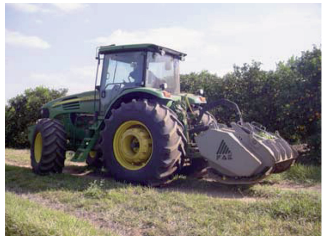
Figura 4. Modelo de equipamento utilizado para a erradicação das plantas com HLB – trincha.
